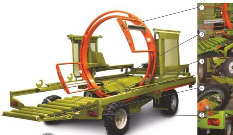
1 Каретка снабжена натяжным устройством для плотной обмотки рулонов.
