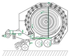
Механизм укладки улучшает подачу влажной и короткостебельной сухой массы в прессовальную камеру, что способствует более качественному подбору даже в случае неровного рельефа почвы, сохранению формы рулона и более легкому разворачиванию во время кормления.
