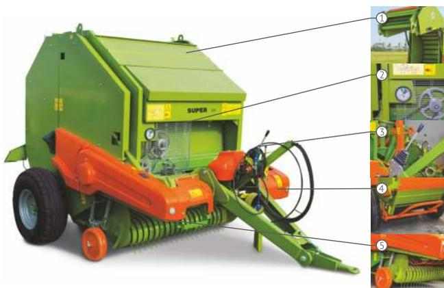
1 Камера постоянного объема, формирует высокоплотные рулоны идеальной цилиндрической формы. Имеет увеличенное количество прессующих валов, изготовливаемых из высоколегированной стали: валы и цепи обеспечивают прессование травяной массы повышенной влажности.
