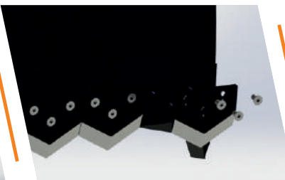
Съемные фрезерованные передние ножи
