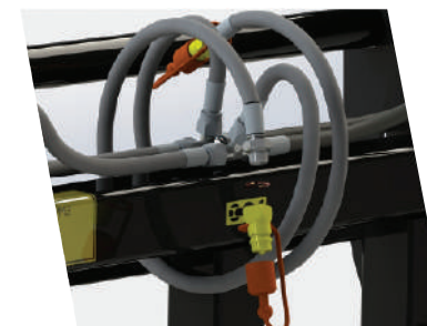
Быстроразъемные соединения гидравлики
